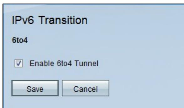
Passaggio 2. Selezionare la casella di controllo **Abilita tunnel 6to4** per abilitare la transizione IPv6
