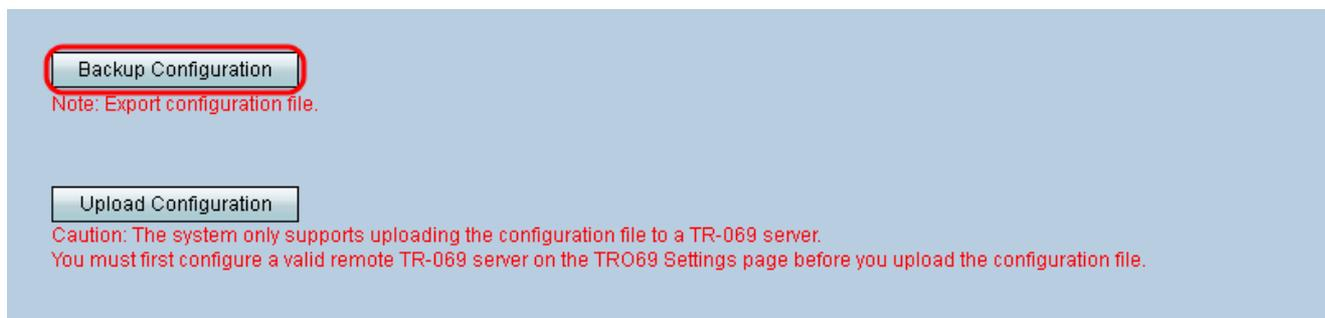
Passaggio 5. Per caricare la configurazione in un sistema di gestione della rete (NMS) di livello superiore, fare clic su **Upload Configuration**. Come indicato nell'avviso, è necessario configurare un server TR-069 prima di caricare il sistema.
