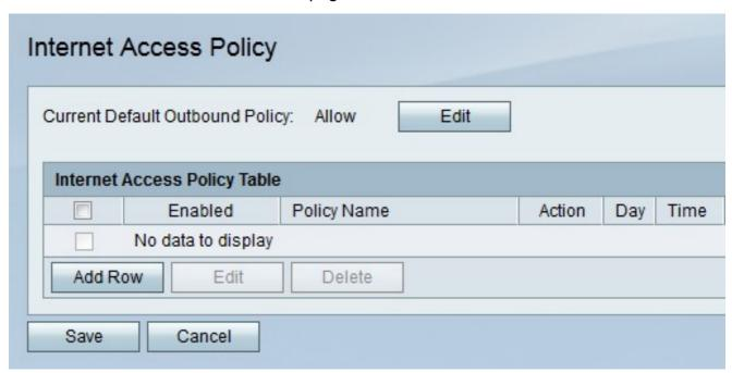
**Nota:** Lo stato predefinito dei criteri in uscita viene visualizzato nel campo Criterio corrente in uscita predefinito. Il criterio predefinito per il traffico in uscita determina se il traffico in uscita è consentito o negato. Viene utilizzato quando non esistono regole di accesso o criteri di accesso a Internet configurati per l'indirizzo IP di un utente. Fare clic su **Modifica** per configurare il criterio per le connessioni in uscita nella pagina *Regole di accesso*.
