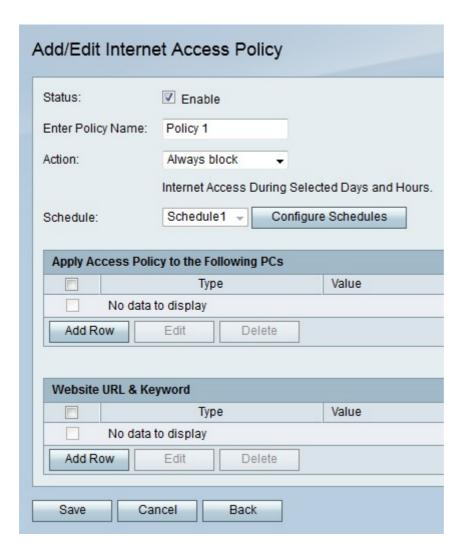
Passaggio 3. Selezionare Abilita nel campo Stato per abilitare i criteri di accesso.
