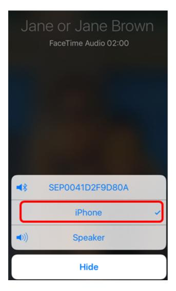
Passaggio 3. Per spostare l'audio sul telefono IP dal dispositivo mobile, toccare l'ID del dispositivo.
