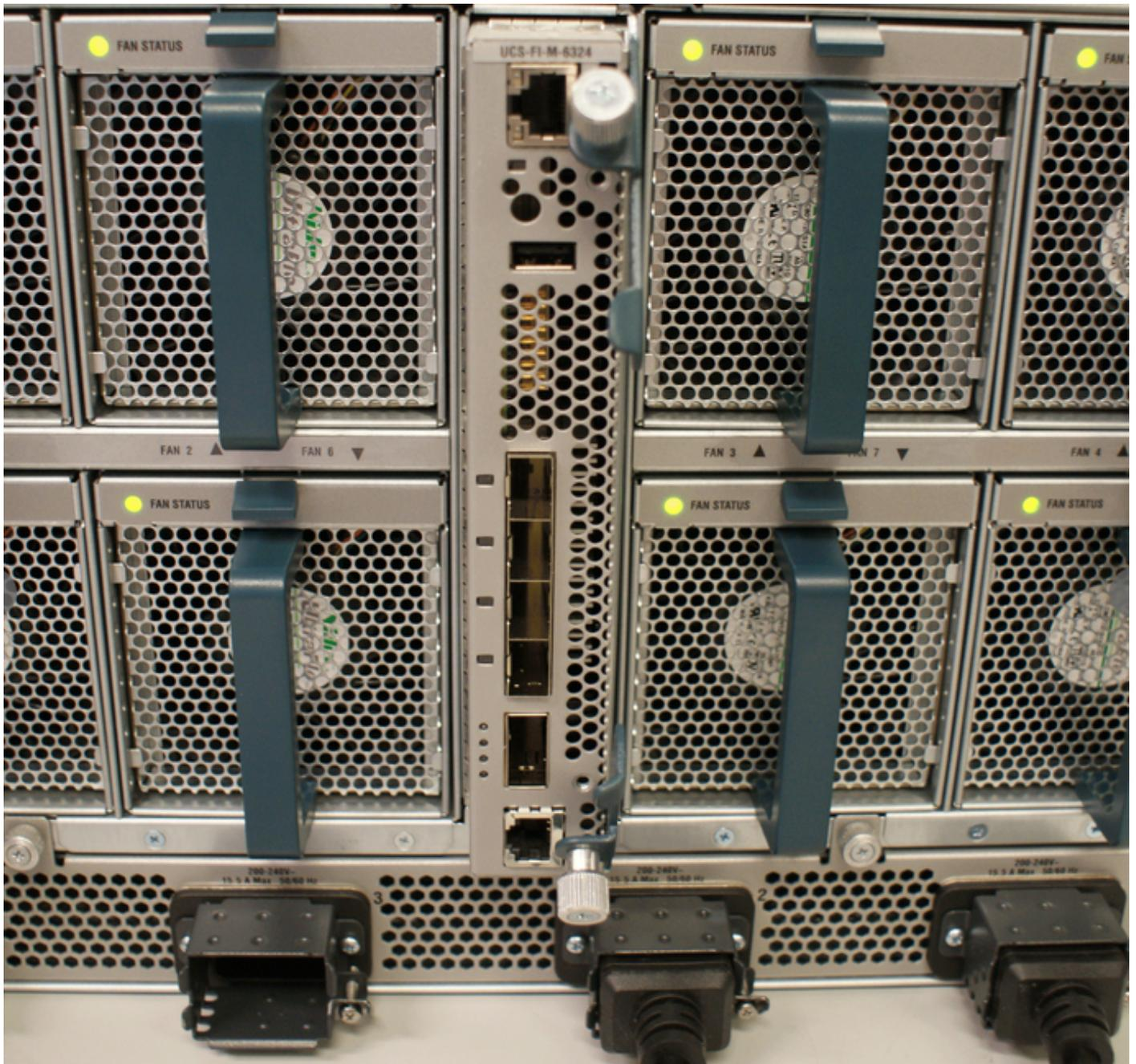
L'interfaccia da 40 Gbit (Scalability Port) può essere utilizzata con un cavo breakout che si trasforma in 4 cavi da 10 Gbit.
