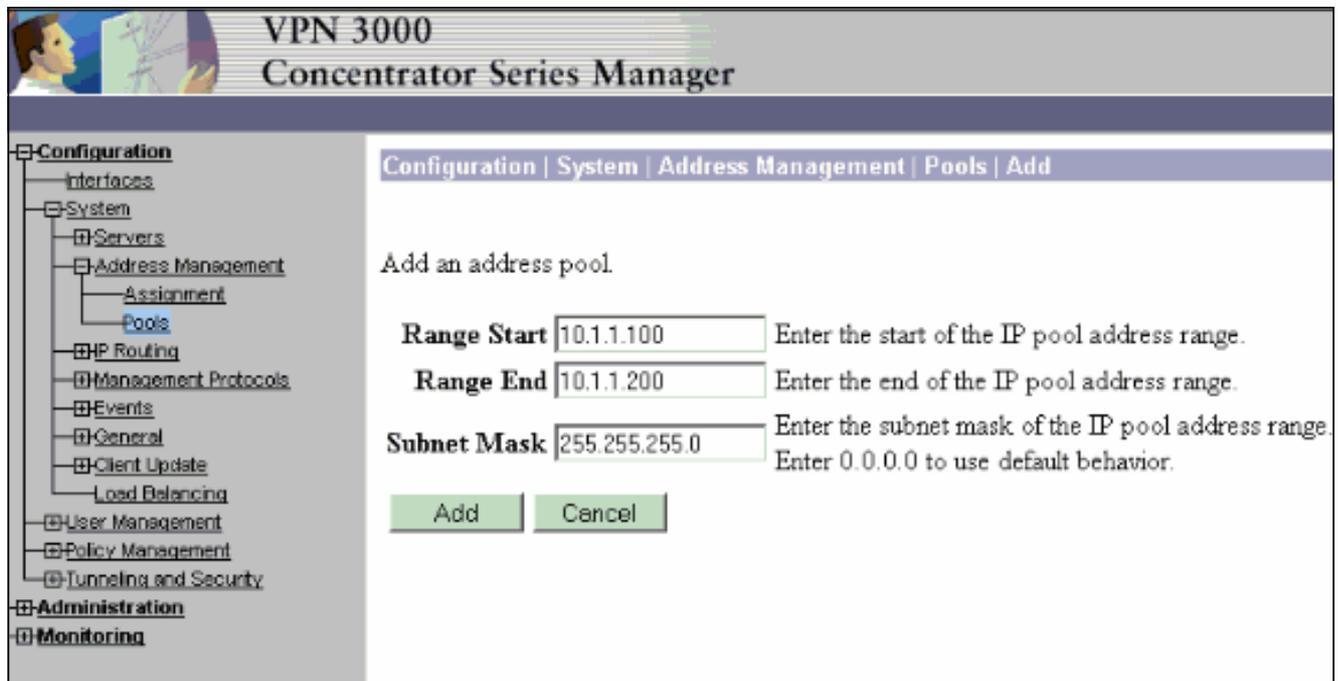
4. Scegliere Configurazione > Sistema > Gestione indirizzi > **Assegnazione**, selezionare la casella **Utilizza pool di indirizzi** e fare clic su **Applica** per indicare a VPN Concentrator di utilizzare il pool.
