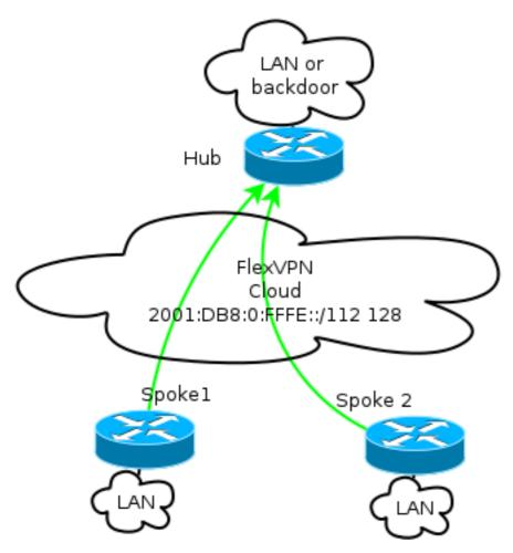
Ogni spoke viene assegnato da un pool di indirizzi di /112, ma riceve un indirizzo /128. Pertanto, la notazione '/112 128' viene utilizzata nella configurazione del pool IPv6 dell'hub.
