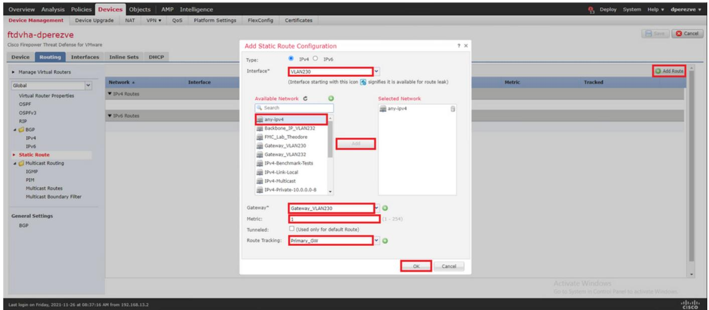
È necessario configurare una seconda route statica per il gateway di backup.
