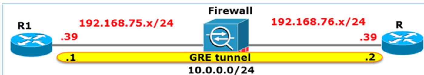
Quando si esegue il ping da R1 a R2 con l'uso di un tunnel GRE, il traffico attraversa il firewall come mostrato nell'immagine.
