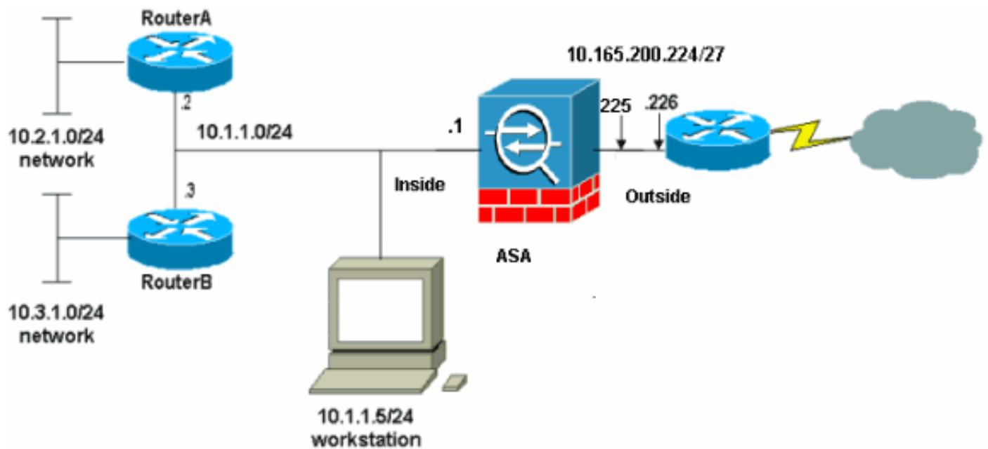
**Nota:** gli schemi di indirizzamento IP utilizzati in questa configurazione non sono legalmente instradabili su Internet. Si tratta degli [indirizzi RFC 1918](#) utilizzati in un ambiente lab.
