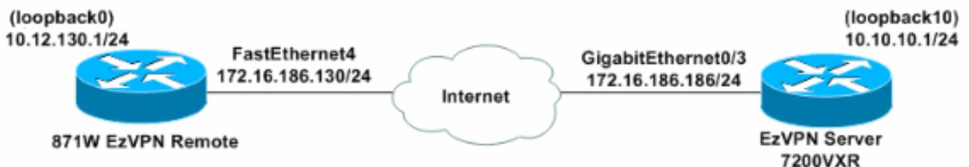
**Nota:** le interfacce di loopback stanno simulando i PC interni.
