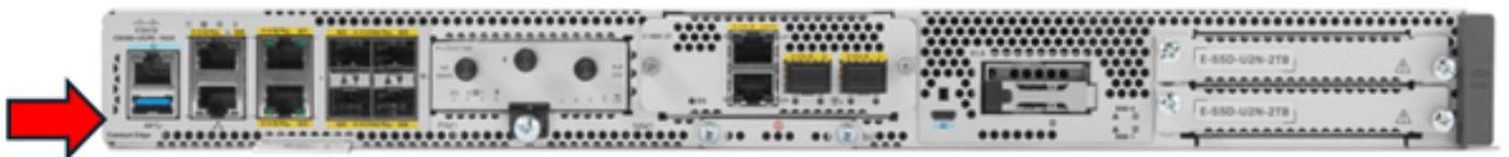
Una volta connessa la memoria, si procede alla spegnimento e alla riaccensione del dispositivo. La connessione della console è un must. È molto importante accedere al menu di selezione dell'avvio e selezionare l'unità USB come dispositivo di avvio. A tale scopo, è necessario premere il tasto F6 una volta visualizzato questo messaggio:
