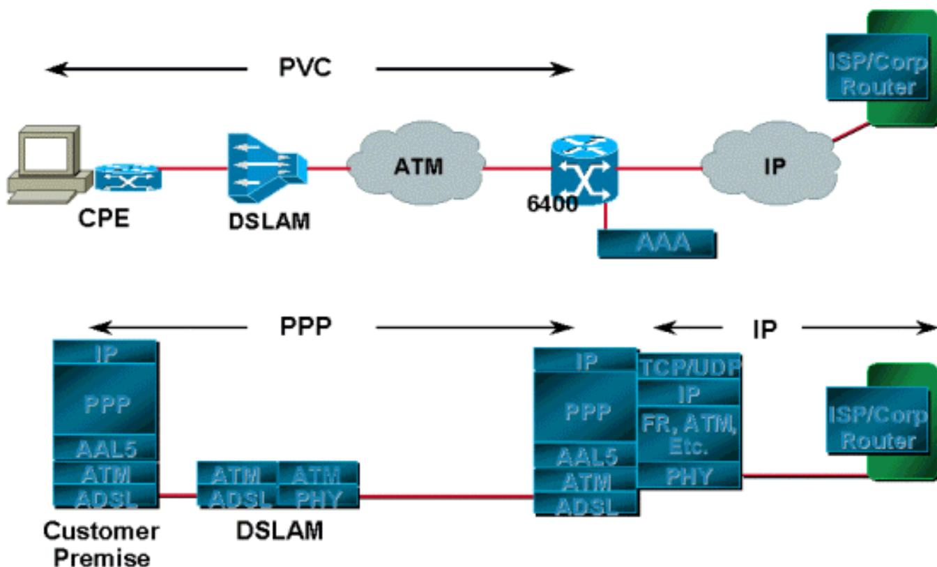
Le sessioni PPP avviate dal sottoscrittore vengono terminate dal provider di servizi che autentica gli utenti utilizzando un database locale sul router o tramite server RADIUS. Dopo l'autenticazione
