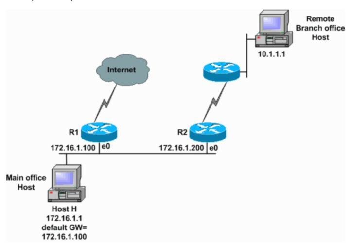
Questo messaggio di debug visualizza il router R1, come nel diagramma della rete, e invia un messaggio di reindirizzamento ICMP all'host H (172.16.1.1).
