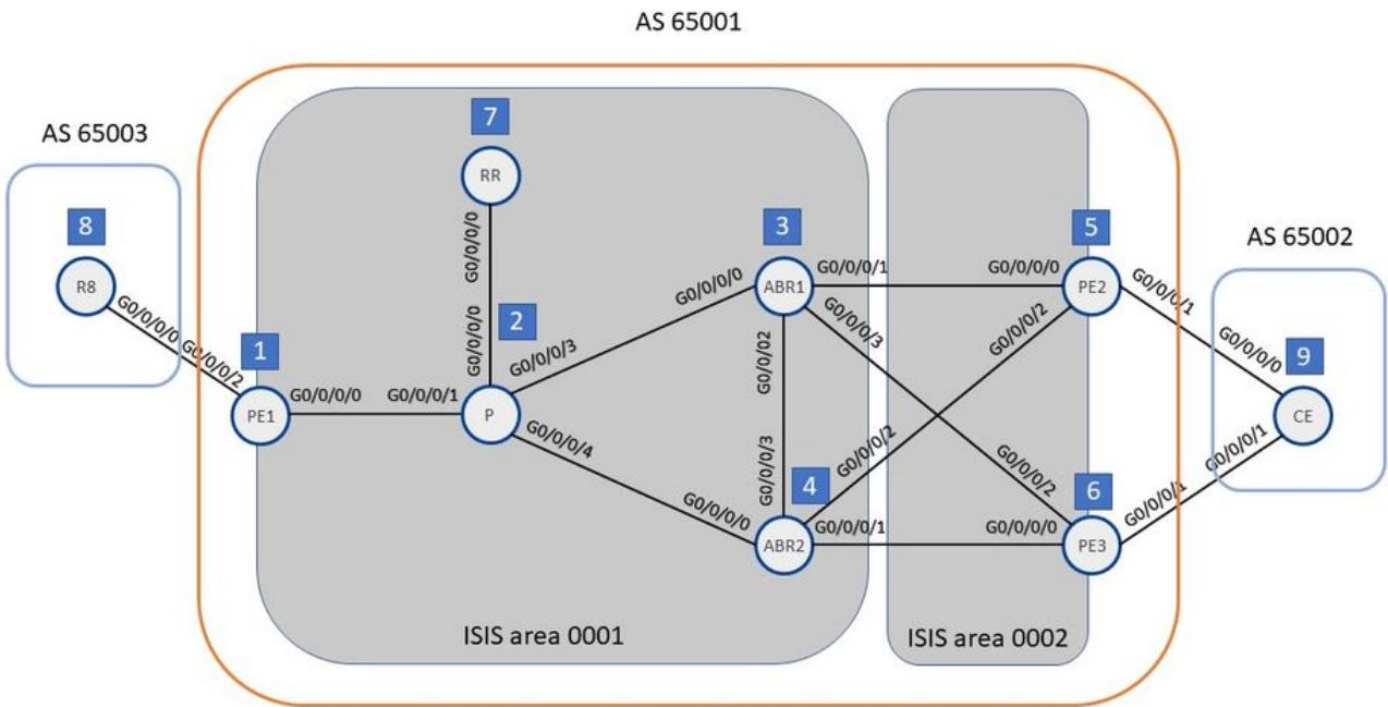
Esistono tre possibili percorsi per la rete 10.99.99.99/32 dal router PE1. Il prefisso 10.99.99.99/32 viene annunciato da R8 e dal router CE.
