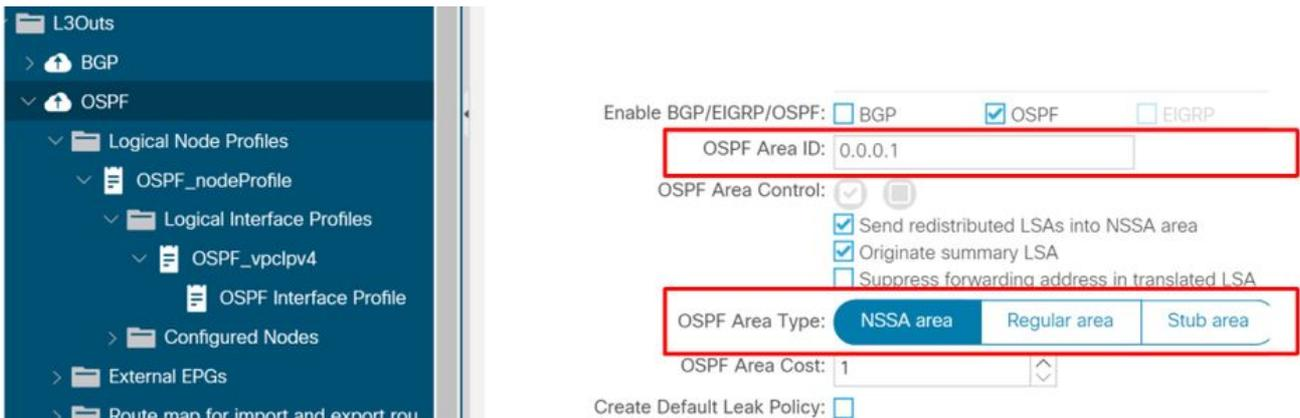
Come per qualsiasi dispositivo di routing, è necessario che ID e tipo dell'area OSPF corrispondano su entrambi i router adiacenti. Di seguito sono riportate alcune limitazioni specifiche ACI relative alle configurazioni di ID area OSPF:
