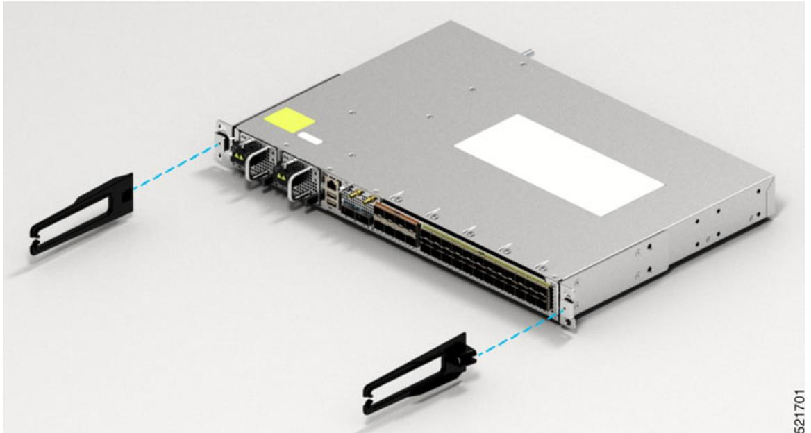
*Illustration 6 : Installation des supports de gestion des câbles (N540-CBL-BRKT-FHC) et de montage en rack 19 pouces (N540DD-RKM-19) au milieu*
