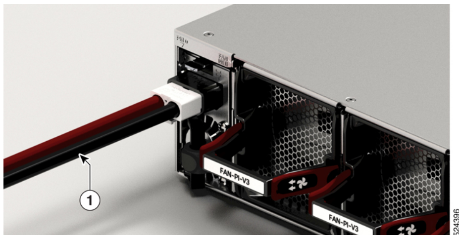
Illustration 69 : Connexion de l'alimentation CC : Cisco 8712-MOD-M
