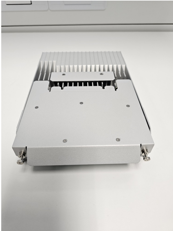
Illustration 5 : Faire glisser l'unité de ventilation de remplacement dans le module 10G
