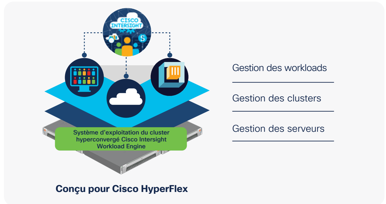
Illustration 1 : Architecture hyperconvergée intégrée Cisco
