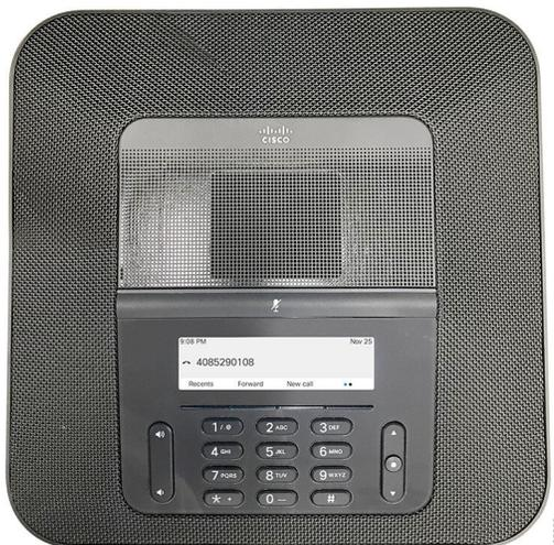
Vous pouvez connecter deux microphones filaires d'extension ou deux microphones d'extension sans fil au téléphone pour augmenter la couverture dans les grandes salles de conférence. Le nombre maximum de microphones est de deux. Les microphones filaires et sans fil ne peuvent pas être mélangés.
