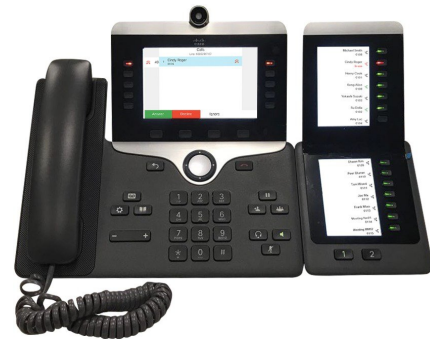
Illustration 7 : Module d'extension de touches pour téléphone IP Cisco 8865 avec deux écrans
