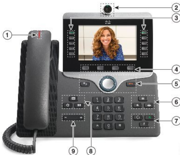
Illustration 1 : Boutons et matériel du téléphone IP Cisco 8845
