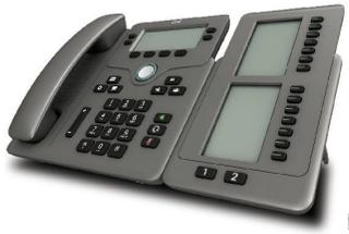
Le téléphone multiplateformes IP Cisco 6851 ne prend en charge qu'un module d'extension de touches. Le module d'extension de touches fournit 14 lignes ou boutons programmables, et deux pages. Chaque page contient 14 lignes ou boutons.
