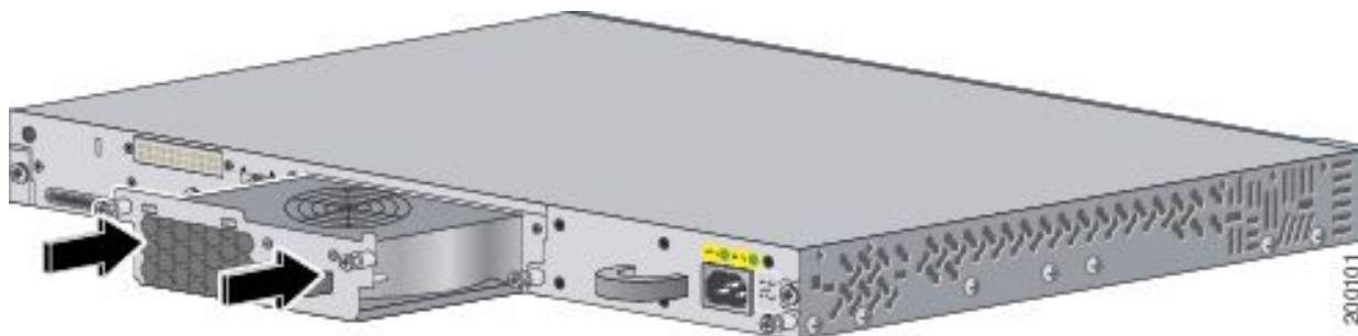
Figure 3-13 Insertion du module de ventilation dans les commutateurs Catalyst 3560E-12D et 3560E-12SD (commutateur Catalyst 3560E-12D représenté dans cet exemple)
