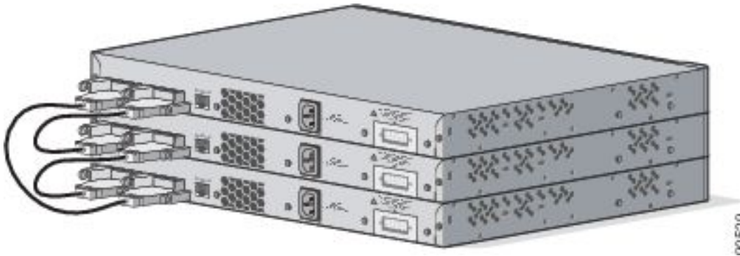
Figure D-2 Empilage des commutateurs
