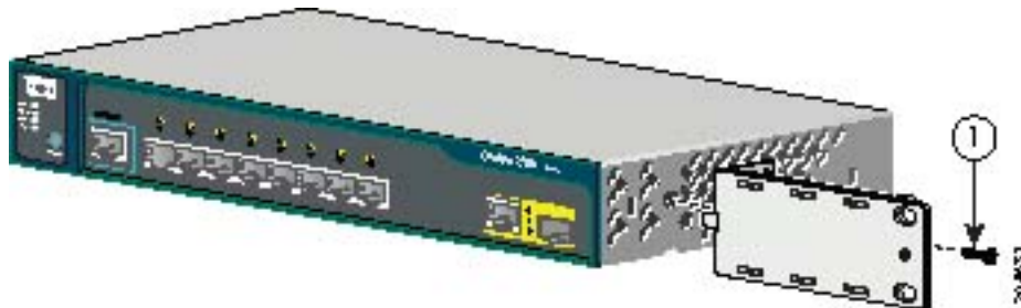
Figure 3-8 Fixation des supports 19 pouces lors d'un montage sur bâti
