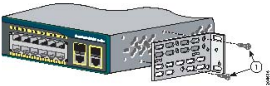
Figure 2-6 Fixation des supports pour bâtis Telco de 19 pouces sur un commutateur Catalyst 2960
