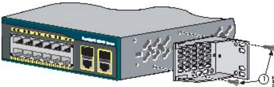
Figure 2-7 Fixation des supports pour bâtis Telco de 24 pouces sur un commutateur Catalyst 2960
