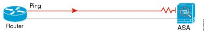
Illustration 4 : Échec de ping, car l'ASA n'a pas de route de retour
