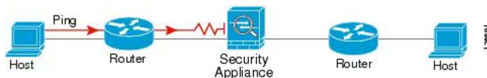
Illustration 5 : Échec de ping parce que l'ASA ne traduit pas les adresses
