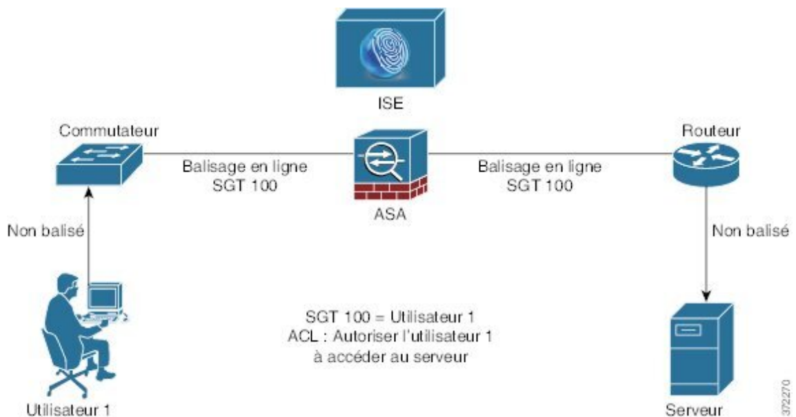
Illustration 3 : Imposition SGT de couche 2
