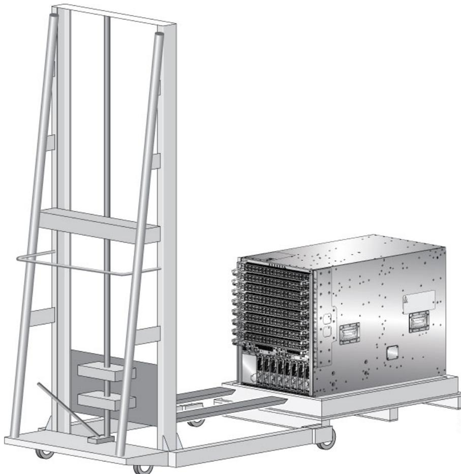
**Étape 2** Préparez-vous à utiliser le dispositif de levage mécanique en disposant un bout de carton sur la surface du système de levage (pour éviter de le rayer).
