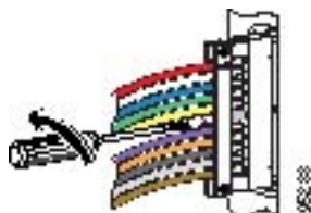
Figure 6 Desserrage de la vis mère
