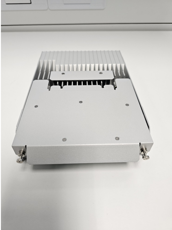
Illustration 5 : Insertion du tiroir de ventilation de remplacement dans le module 10G
