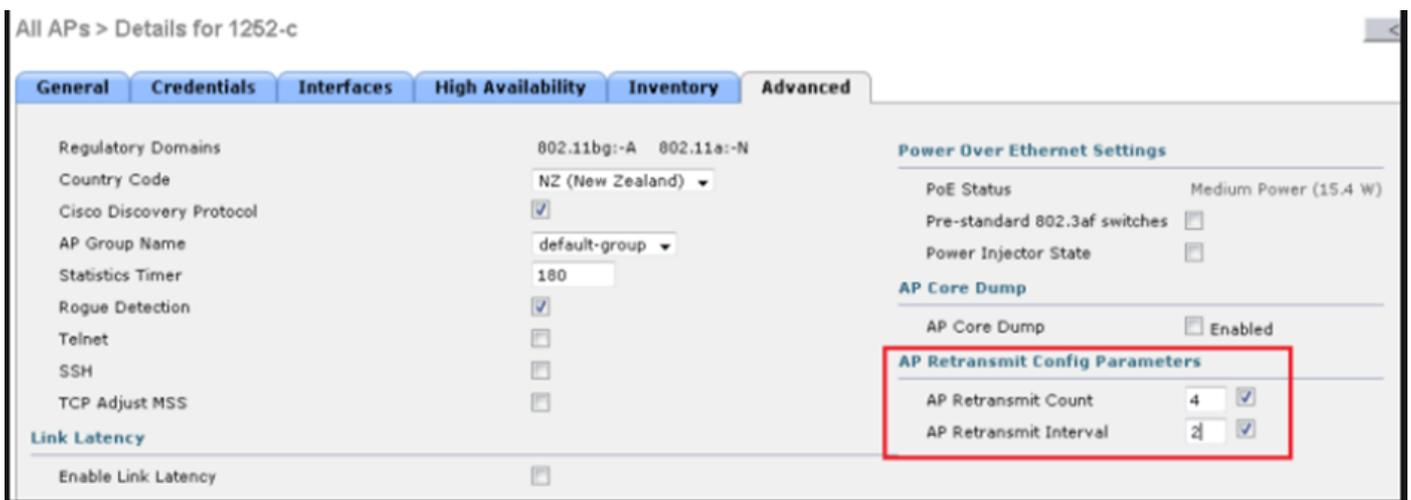
Possibilité de modifier le paramètre de configuration de retransmission AP sous un AP spécifique
