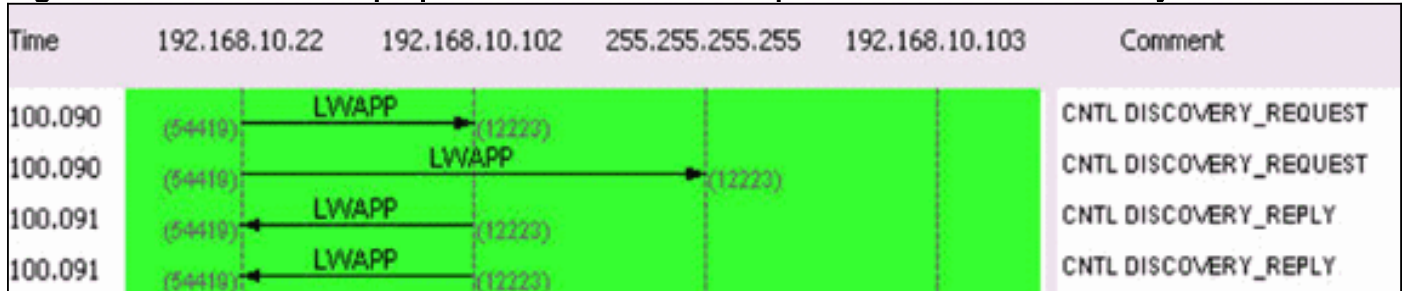
Figure 2 : Écoulement de paquet de demande et de réponse de LWAPP discovery
