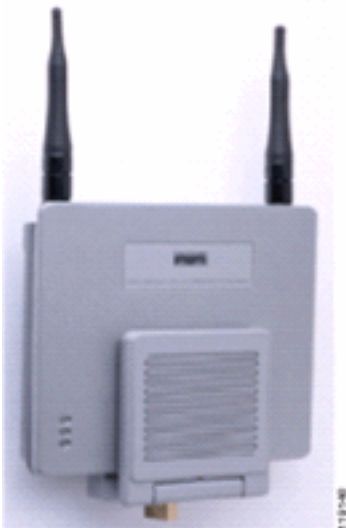
Figure 23 — Cisco AP1200 monté à un mur
