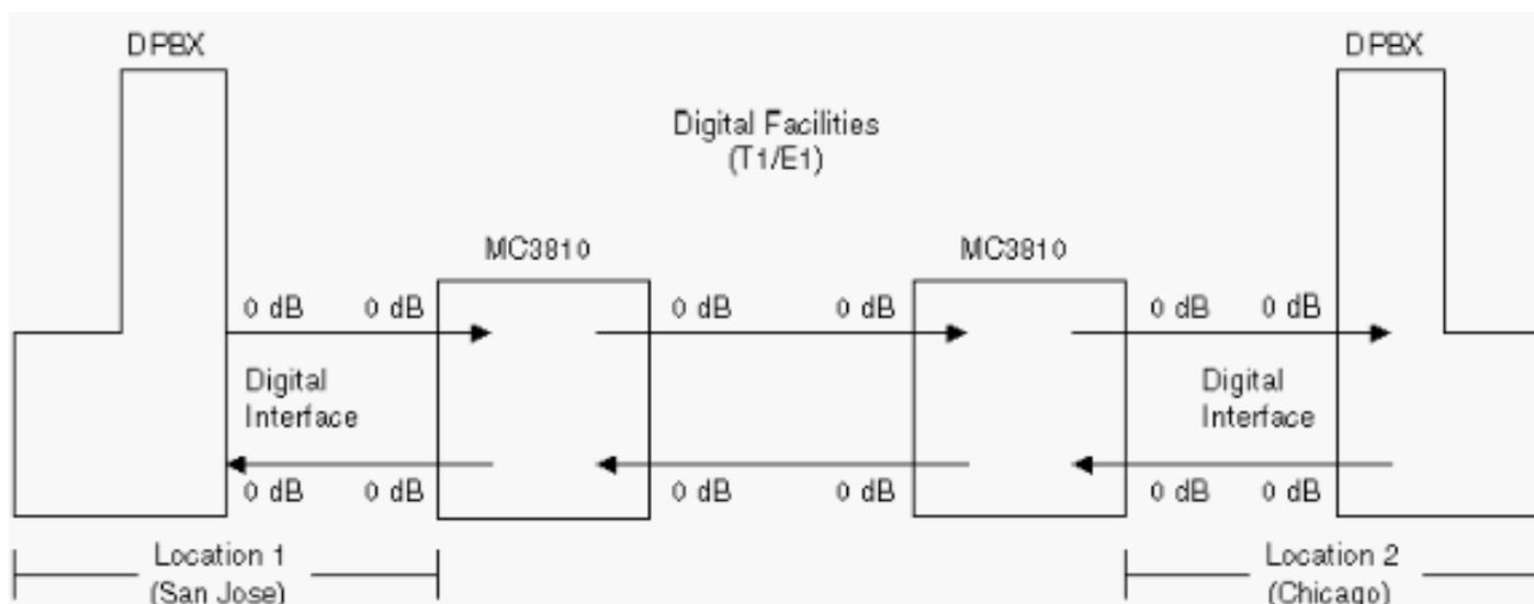
Pour la majorité de réalisations de Cisco MC3810, DPBXs font partie du réseau client global. Par exemple, la topologie du réseau peut ressembler à ceci :
