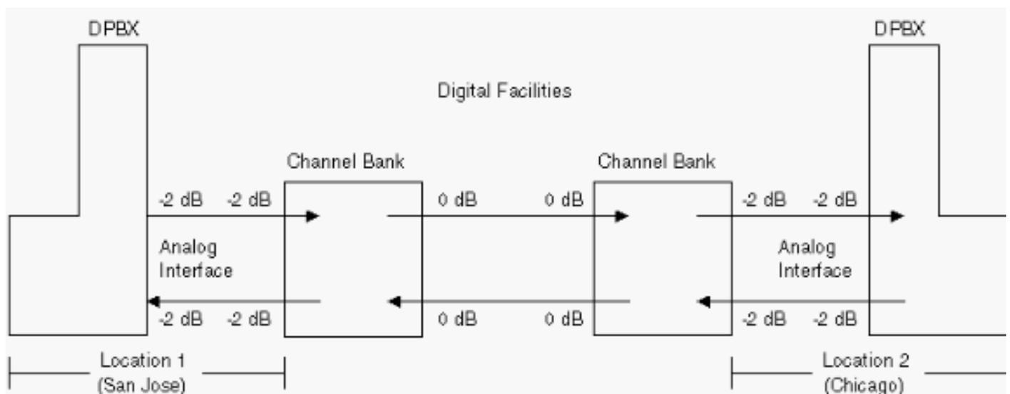
S'il y a seulement un CB et il se connecte à un DPBX par une interface analogique, les niveaux sont -2.0 dB transmettent et -4.0 dB reçoivent (voir la cette figure).
