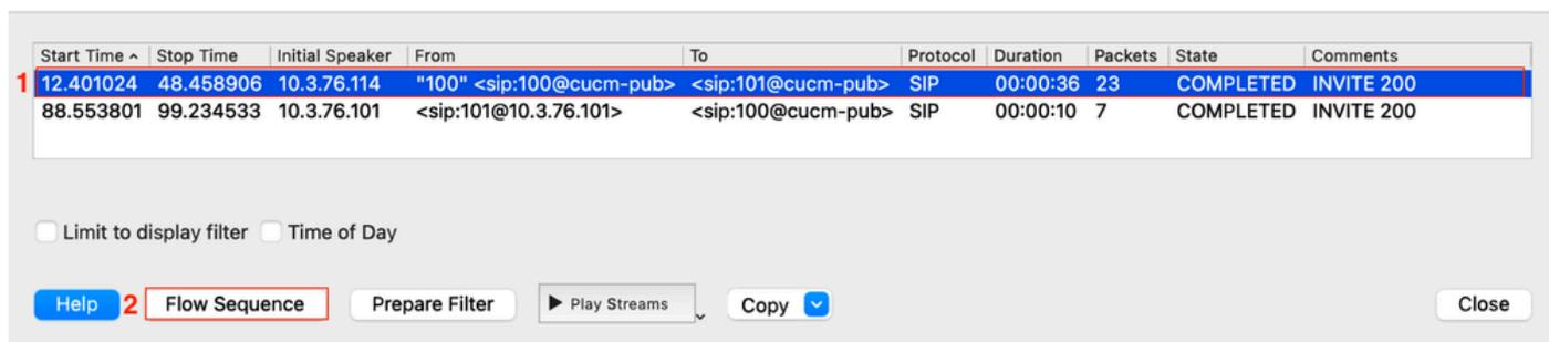
7. Wireshark affiche le diagramme de flux d'appels du point de vue du périphérique. Identifiez les périphériques réseau faisant partie du flux et analysez la signalisation SIP à la recherche d'erreurs
