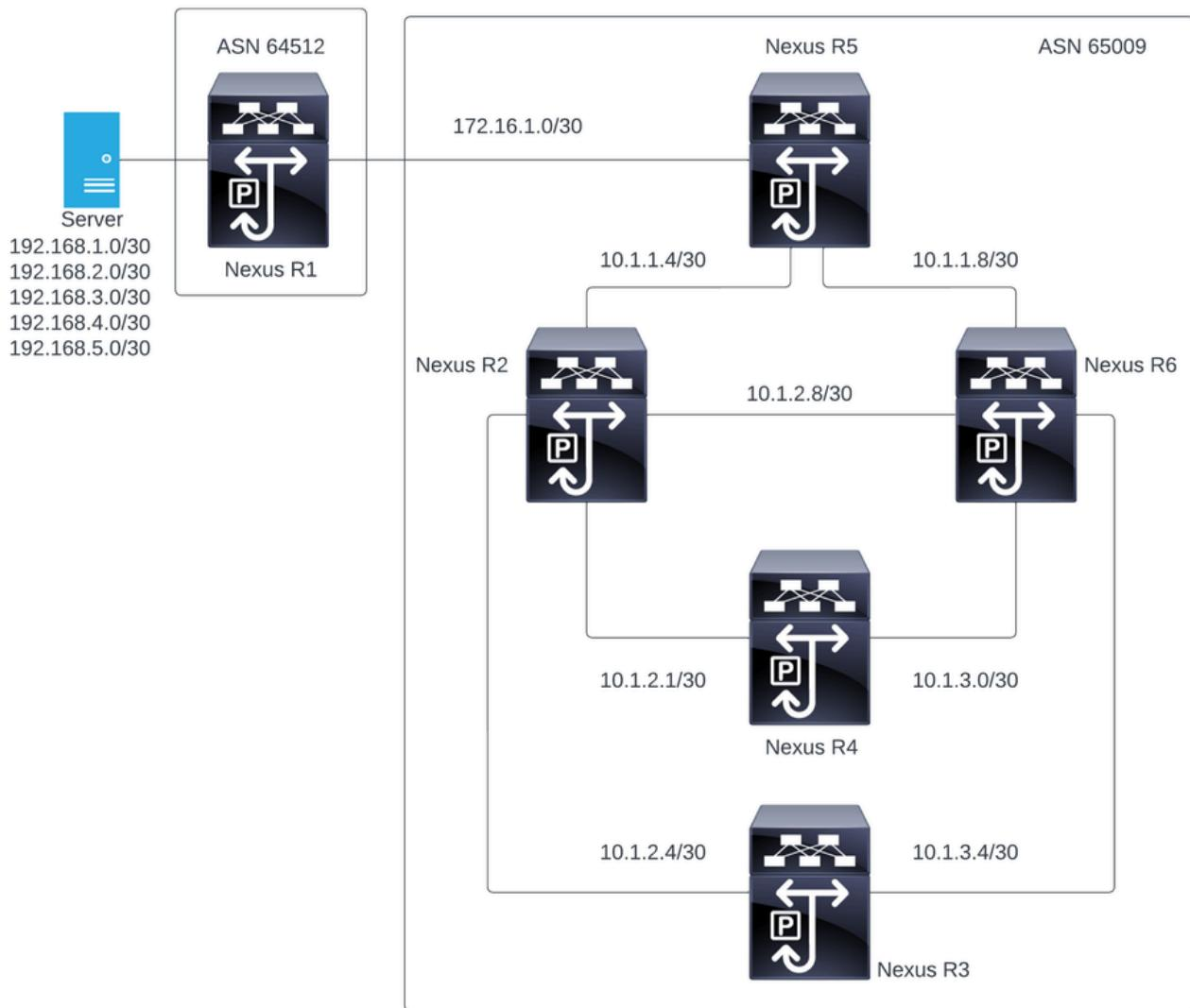
Dans cette figure, les commutateurs Nexus R2, Nexus R3, Nexus 4, Nexus R5 et Nexus R6 établissent un voisinage iBGP. De plus, les routeurs Nexus R1 et Nexus R5 établissent un voisinage eBGP.
