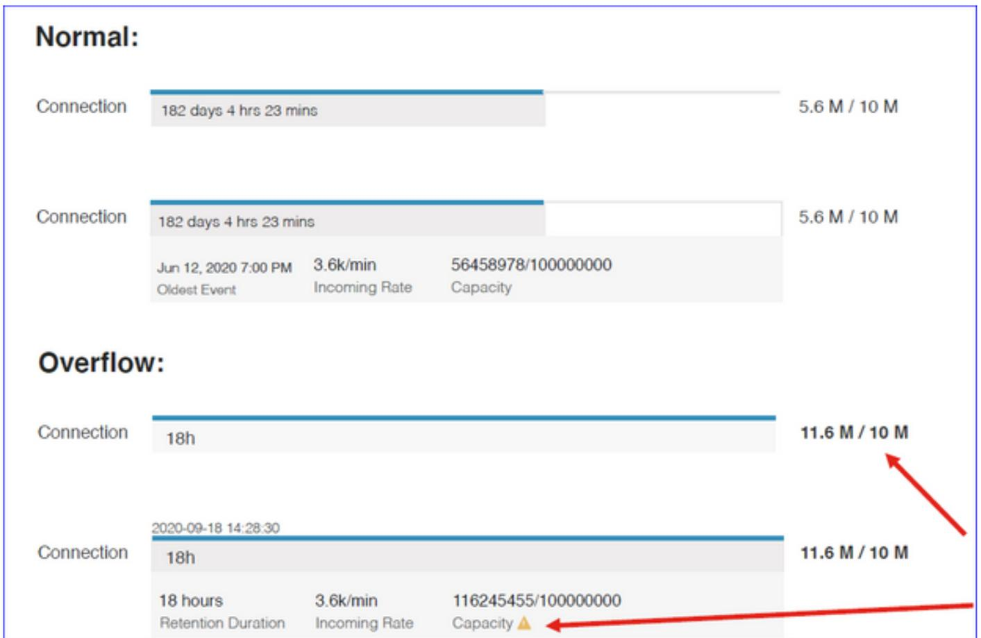
Scénario de dépassement, lorsque les événements sont stockés au-delà de la capacité maximale configurée.
