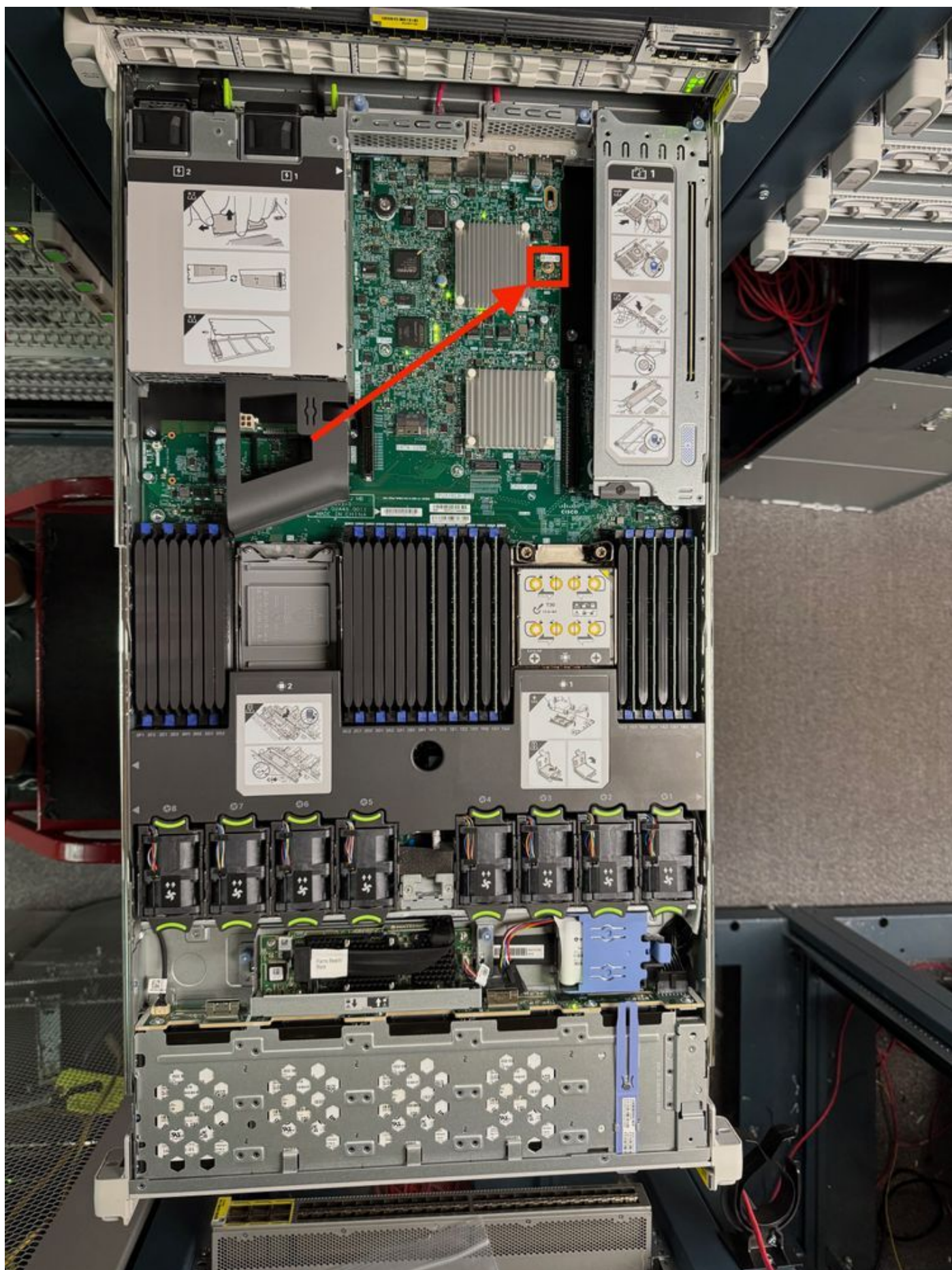
Image 1. Emplacement du module TPM dans l'appareil SNS 3700
