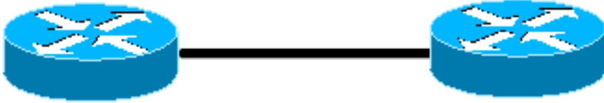
Figure 6 – Les Routeurs ont connecté dos à dos
