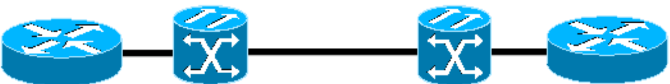
Figure 5 – Réseau non protégé DWDM
