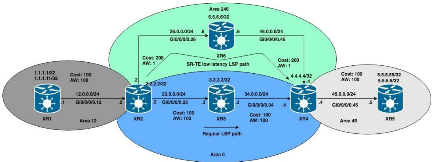
Dans les cas suivants, nous utiliserons cette topologie interzone OSPF et les exemples seront basés sur la tentative de calcul des tunnels SR-TE de XR1 à XR5 traversant les limites de la zone.
