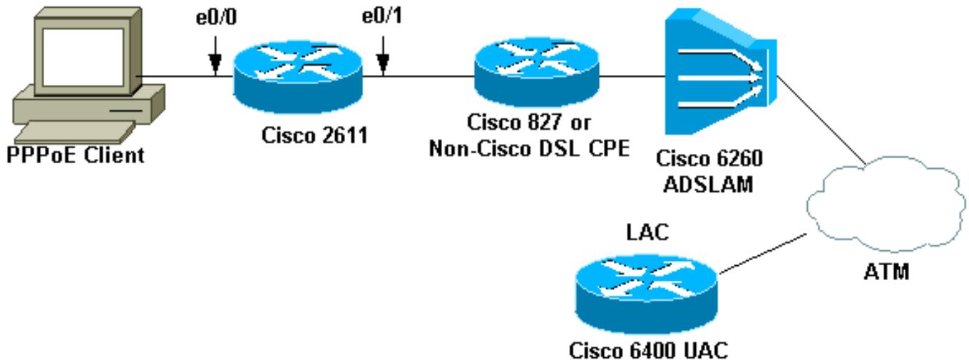
**Remarque:** Dans ce document, la connexion de PPPoE Client est initiée du routeur de Cisco. C'est le routeur de Cisco 2611 dans cette configuration. Le routeur de Cisco 827 dans le diagramme représente la CPE DSL de non-Cisco.
