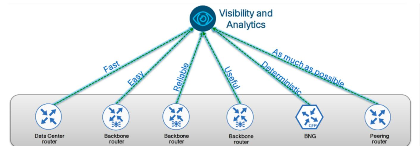
En général, les fonctions de visibilité et d'analyse sont situées dans des points centraux des réseaux, la transmission en continu des informations télémétriques est effectuée à l'aide de mécanismes de transport réseau, de sorte que les informations télémétriques doivent être aussi
