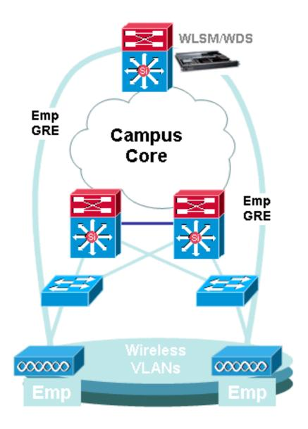
Notez qu'un VLAN est encore associé avec chaque SSID. Ces VLAN sont maintenant définis seulement sur le Point d'accès et n'ont pas besoin d'être configurés sur la couche d'accès ou les commutateurs de la couche de distribution. Le seul but de la partie VLAN de la configuration est de fournir une attache entre le cryptage associé avec le VLAN à une particularité SSID.
