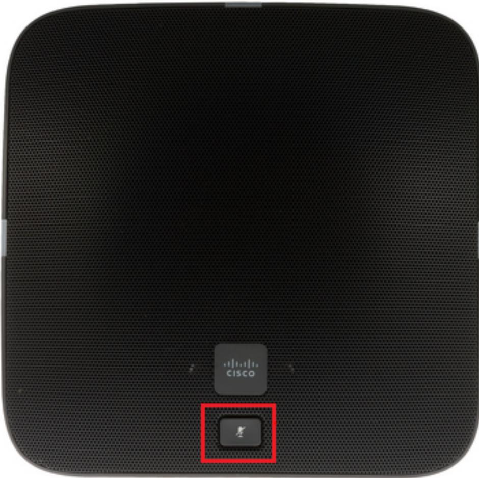
Étape 3. Maintenez le bouton MIC enfoncé et mettez le téléphone sous tension (branchez le câble Ethernet ou la brique d'alimentation). Lorsque les voyants situés sur les côtés gauche, droit et arrière du téléphone passent du vert au rouge, relâchez le bouton MIC, comme illustré dans l'image.
