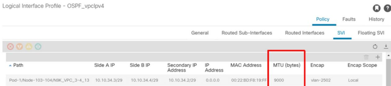
Le MTU par défaut sur l'ACI est de 9 000 octets, au lieu de 1 500 octets, ce qui est généralement le MTU par défaut utilisé sur les périphériques de routage traditionnels. Vérifiez que le MTU correspond au périphérique externe. Lorsque l'établissement du voisin OSPF échoue en raison de MTU, il est bloqué à EXCHANGE/DROTHER.
