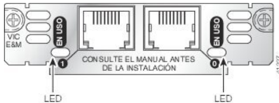
Figura 4: Indicadores LED de la tarjeta de interfaz de voz
