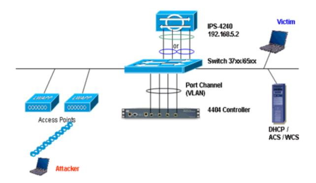
El WLC de Cisco está conectado a las interfaces gigabit en el Catalyst 6500. Cree un canal de puerto para las interfaces gigabit y habilite la agregación de enlaces (LAG) en el WLC.
