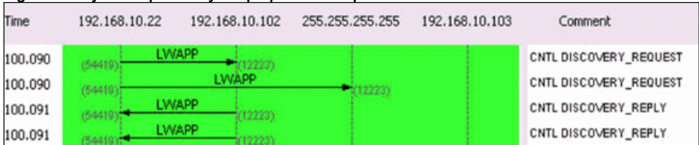
Figura 2: Flujo de la petición y del paquete de respuesta de la detección de LWAPP
